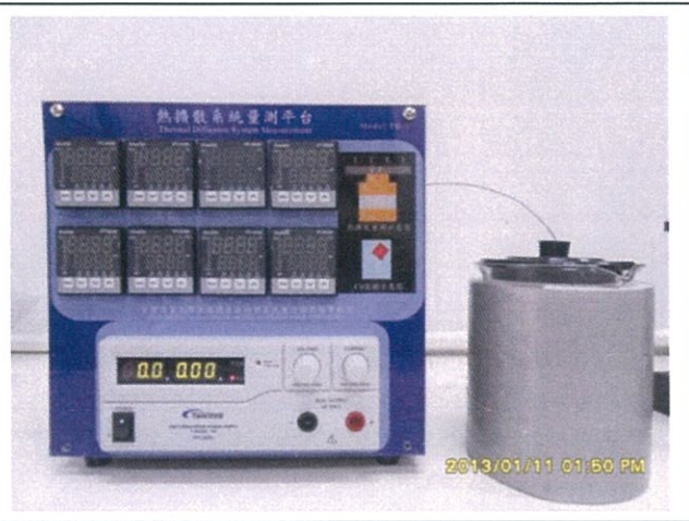
Fig. 6 比熱容量測系統
